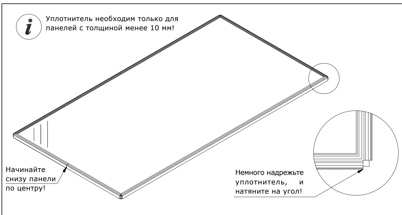
2_ Положите панель на стол, и натяните на неё уплотнитель (только для панелей толщиной менее 10 мм)
